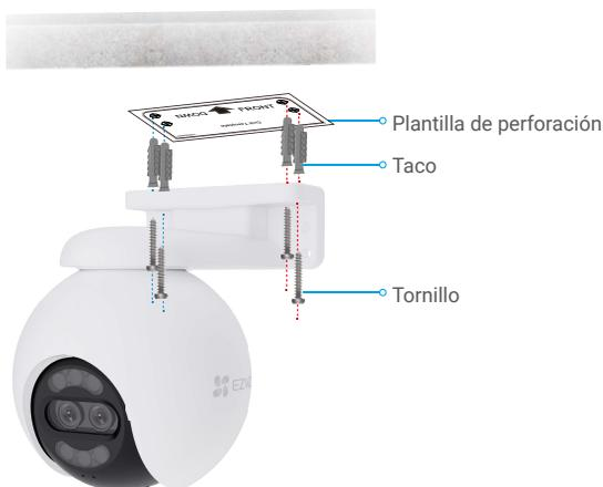
Figura 1. Montaje en techo
